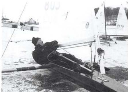
misch, rund 350 Segler betreiben aktiv diesen Sport. Starke Stützpunkte befinden sich vor allem in Steinhude, am Dümmer und in Norddeutschland. Gefahren werden die Eisschlitten auf dem Rücken liegend, mit einer Ruderpinne kann mit der vorderen Kufe gesteuert werden. Bei guten Windverhältnissen erreichen die Fahrzeuge Geschwindigkeiten bis zu 90 km/h, auf völlig glattem Eis kurzzeitig sogar bis 130 km/h.
