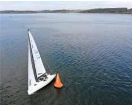
Das System kann aus Eingaben wie Windrichtung, Kursgeometrie und Länge des Kurses die Sollposition der Tonnen berechnen und diese dann dorthin schicken. Dort angekommen halten die Tonnen über ihr integriertes Antriebssystem ihre Position auf gegen Wind und Welle. Es können verschiedene Kursgeometrie
